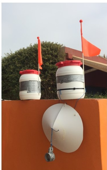
Figure 2.1: Drifter-ontwerp voorbereid voor inzet (links). Schema van de inhoud van de behuizing van de drifter (rechts).
