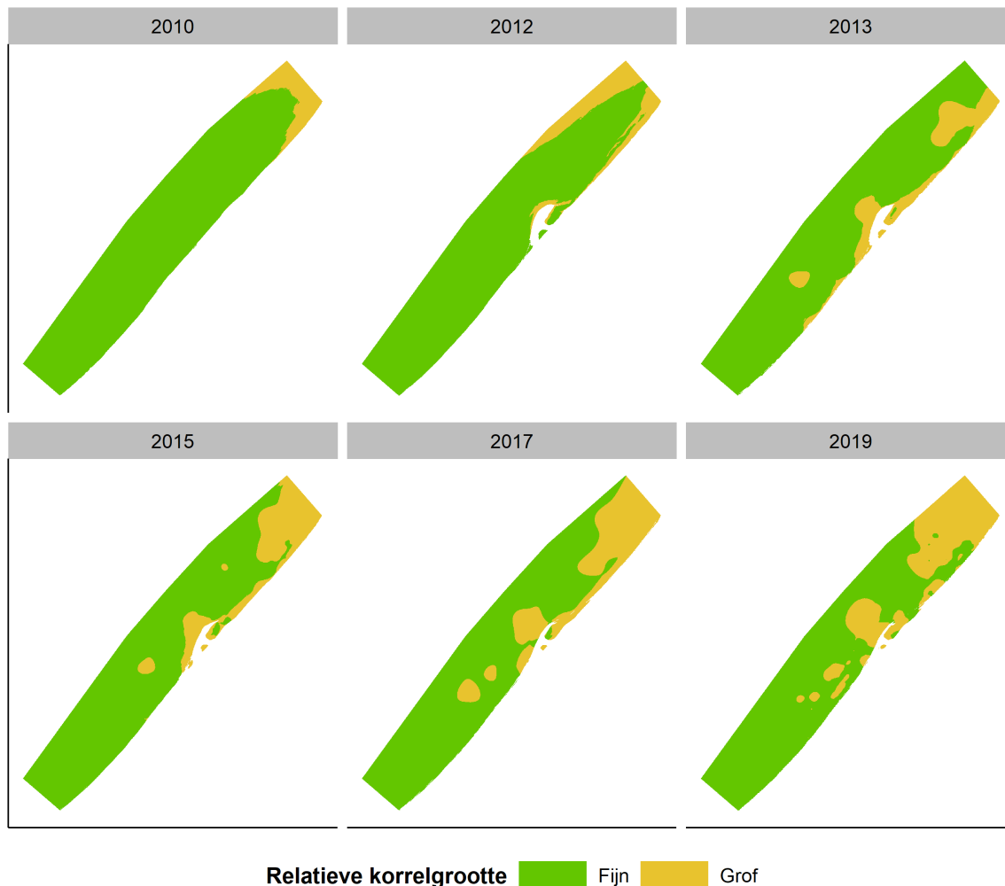
Figuur 17 Mediane korrelgrootte rond de Zandmotor over de tijd per categorie. Relatief fijne korrels hebben een mediane korrelgrootte kleiner dan 350 \mu\text{m} en relatief grove korrels hebben een mediane korrelgrootte groter dan 350 \mu\text{m} . Met deze categorieën blijven de algemene patronen die in Figuur 6 te zien zijn zichtbaar in de kaarten. Het strand van de Zandmotor is weggelaten op deze plots, omdat er voor de interpolatie geen monsters zijn meegenomen op de Zandmotor zelf.
