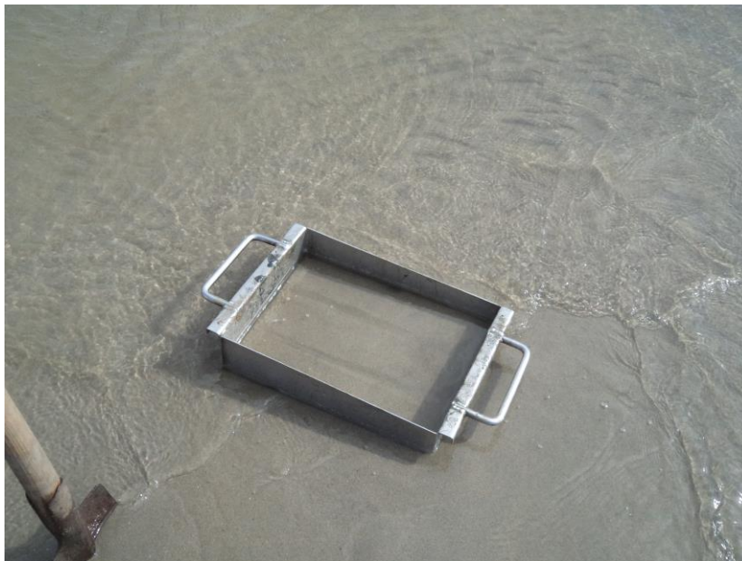
Figuur 7: RVS frame voor de strandbemonstering. NB op de foto is er water in het frame gestroomd. Tijdens de bemonstering zou deze opnieuw worden gestoken om te voorkomen dat bijvoorbeeld amphipoden weg kunnen zwemmen.
