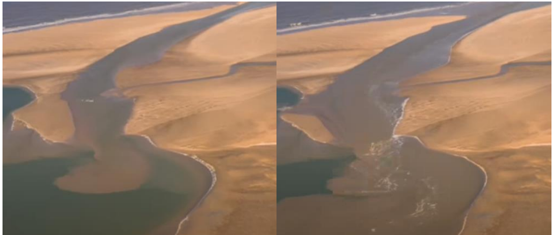
Figuur 3.4 Sedimentpluim bij instroming van de lagune van de Zandmotor in 2016 (film materiaal, Shore in opdracht van de Provincie Zuid-Holland; Shore, 2016).
