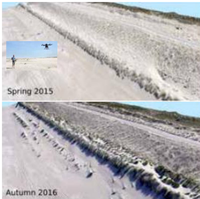
Figuur 3.10 Drone opnames van de verandering in morfologie en vegetatie op de zeereep landwaarts van de Zandmotor (Van Puijenbroek et al., 2017; Nolet et al., 2018)
