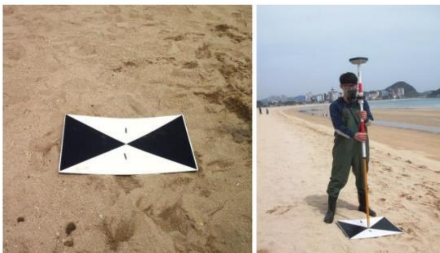
Figuur 2.1 Marker van een GCP locatie (Yoo et al., 2016)
