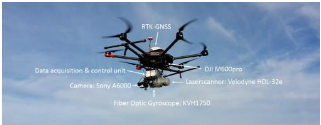
Figuur 1.1 Voorbeeld van een drone met laserscanner en camera (Shore, 2019).
