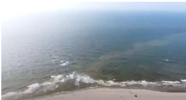
Figuur 3.5 Loslating van stroming en sedimentpluim op de kop van de Zandmotor in 2018 (film materiaal, Matthieu de Schipper, TU-Delft; De Schipper, 2018b).
